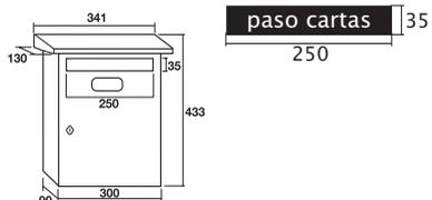
Fabricados en acero. Pintados en poliéster. Líneas clásicas, resistencia y gran capacidad. Peso: 3,1 kg.
